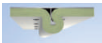
Single layer STEEL A-60 Deck, A-30, A-15
